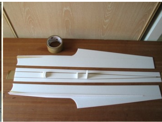
Les flancs avant collage, en utilisant les dépouilles du fond en Dépron de 3 mm comme guides.
