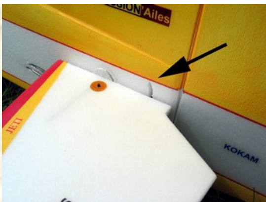
Le stabilisateur est de type monobloc pendulaire.
