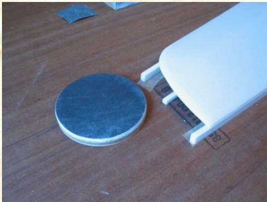
Les saumons sont avantageusement poncés avec une cale ronde.
