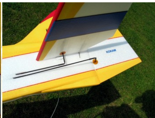
Les commandes sortent à gauche sous le stabilisateur
