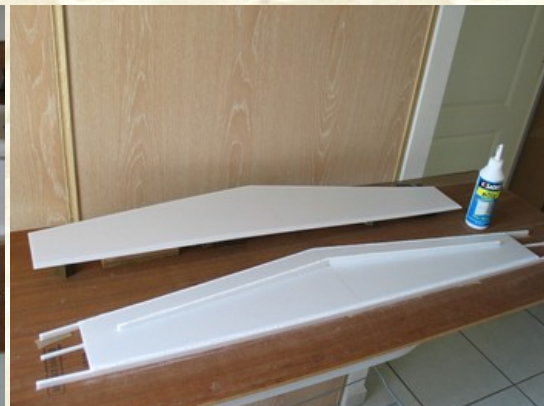
Le longeron vient d'être collé.
