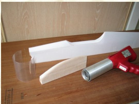
Pour réaliser la verrière, il vous faut un décapeur thermique, de la gaine et la forme en balsa.
