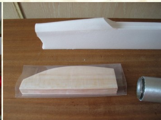
Le dessus du fuselage en Dépron de 2 mm est roulé sur les couples.
