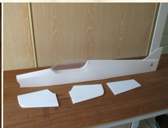
Le fuselage terminé avec le stabilisateur démonté.
