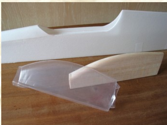
La verrière vient juste d'être thermoformée. Attention les doigts.
