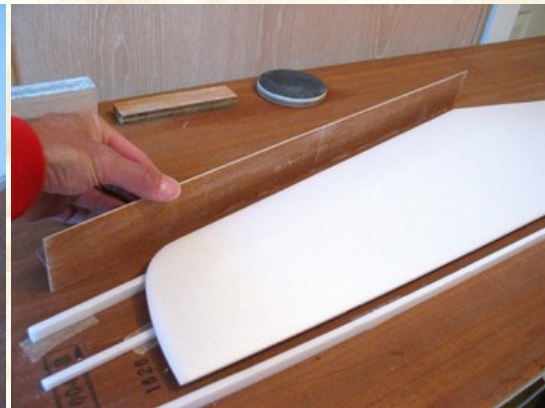
Les bords sont poncés finement avec une cale de grande longueur.
